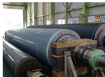
製紙用プレスロールへ溶射加工
